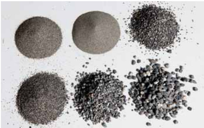
Verschiedene Sandkörnungen für die perfekte Sieblinie von Estrichsand.
