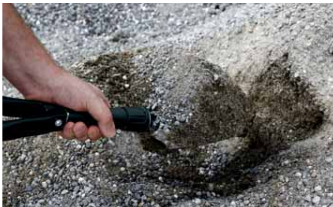
Entnahme einer Sandprobe auf der Baustelle.
