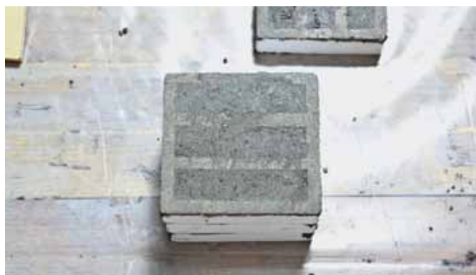
Herstellung von Prismen auf der Baustelle für Druck- und Biegezugprüfungen des Estrichs.
