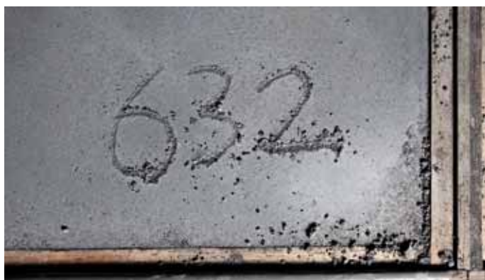
Nachstellung von Baustellenverhältnissen anhand von Prüffeldern zur Qualitätsbestimmung von Sandmischungen.
