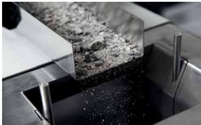
Sieblinienbestimmung mit dem Camsizer.
